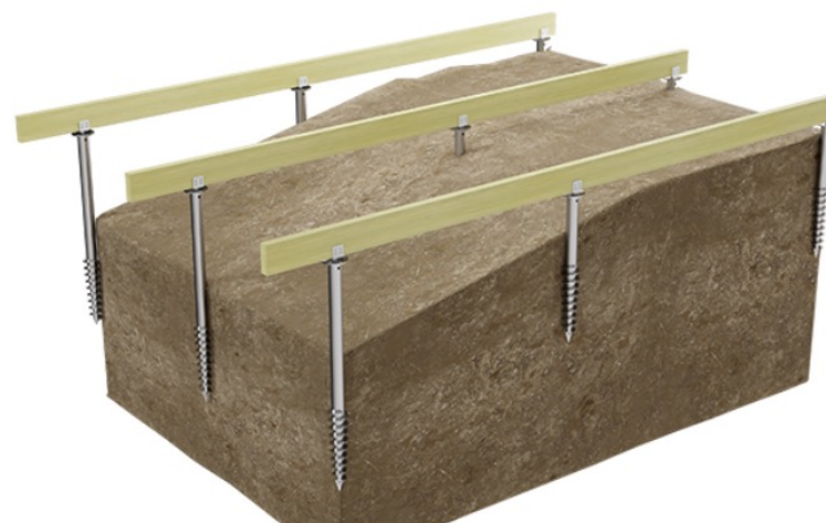
Etape 2 : Pose des solives
